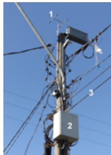
Figura 5. Arriba: Sensor acústico de disparos instalado en un poste de alumbrado público en La Pintana. 1) Arreglo de micrófonos. 2) Gabinete de audio. 3) Red de fibra óptica. Abajo: Vista panorámica desde uno de los sensores acústicos de disparos instalado en La Pintana
