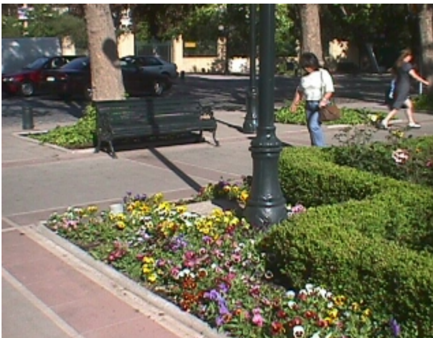
Foto tomada en el borde de la plaza con la calle Pedro de Valdivia. Una excelente decisión es integrar la calle al mismo nivel de la plaza . Esto reduce la velocidad del tráfico vehicular y aumenta la percepción de amplitud espacial.
